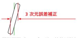
問題:両面プロービング 2 軸外形測定機器では、常にやむを得ない 3 次元アライメント エラーを通して、上のプローブ チップから下のプローブ チップというプロファイル原則の違反が生じます。相互調整を手動でアクティブにする外形測定デバイスでは、この場合のエラー補正ができません。
