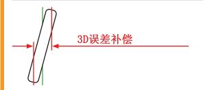
问题:由于上测针到下测针不可避免的3D齿向允差,双面探测的2轴轮廓测量仪从原则上来说,触犯了测针测量的原理。手动操作交叉调整的轮廓测量仪不能提供误差补偿。
